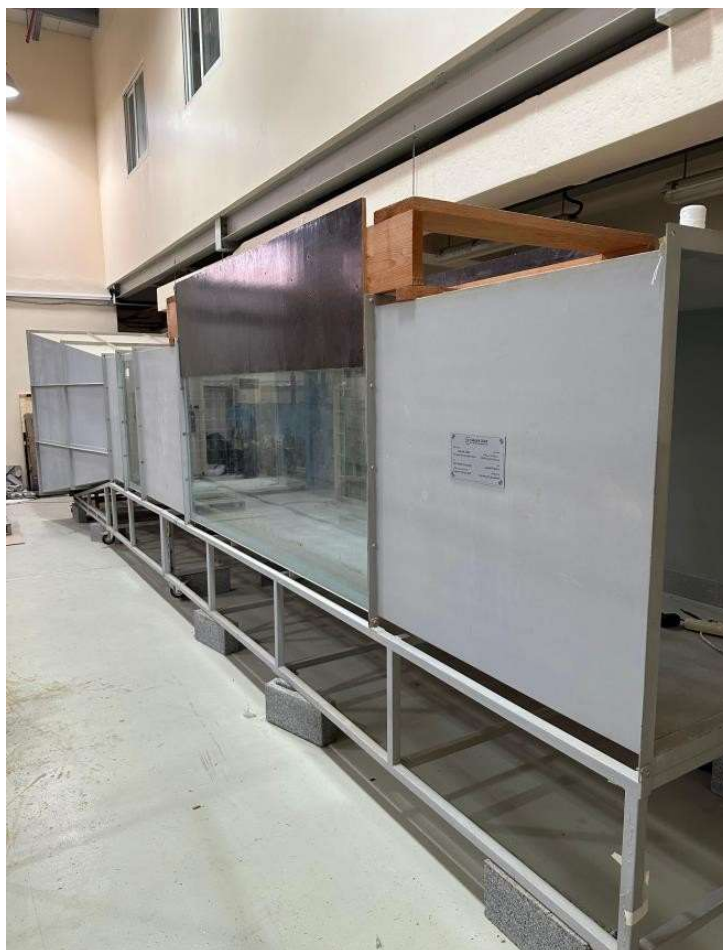
Рисунок 13 - Установка для испытаний в аэродинамической трубе, использованная для проведения экспериментального анализа
