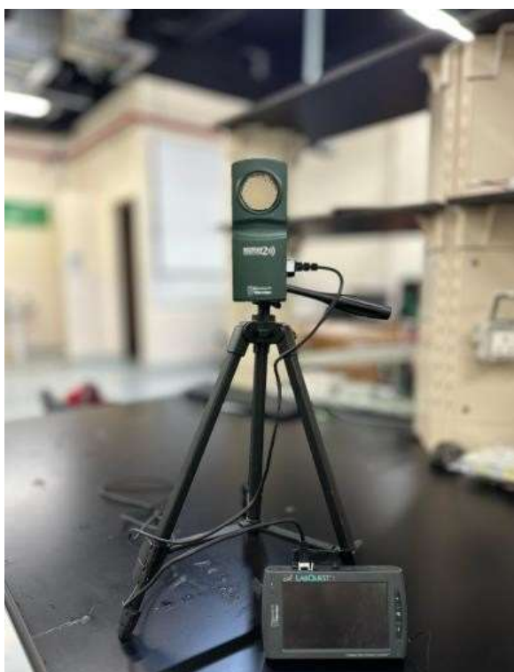
Рисунок 14 - Ультразвуковые датчики обнаружения движения и измерительные приборы используются для измерения смещения, скорости и ускорения БВВТ
